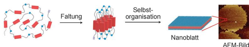
**Alternierende Copolymeren** aus phenyl-funktionalisiertem Dithiophen (rot im Bild) und Oligoethylenglycol organisieren sich in manchen organischen Lösungsmitteln durch Faltung des Polymers hierarchisch in Nanoblätter. Die laterale
